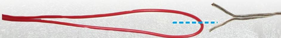
В случае необходимости подключения датчика дождя, разрежьте петлю красного провода, как показано на рисунке, и присоедините оба получившихся конца к концам кабеля датчика дождя.
