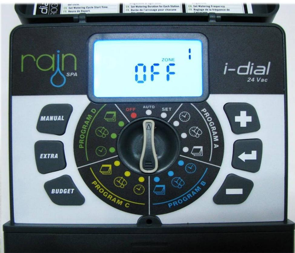
На этом контроллере предусмотрена возможность настройки включения помпы или главного клапана для каждой зоны полива отдельно.
