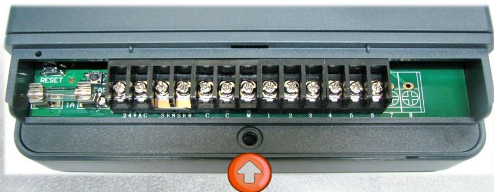
Монтажное отверстие для крепежного метиза.
