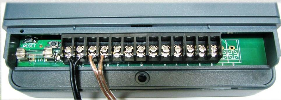
Подсоедините общий кабель (масса) к любому контакту "С". Два контакта дают возможность порознь произвести подключение отдельно для клапанов и для помпы.
