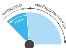
Эта запатентованная функция возвращает башенку дождевателя к изначальному сектору полива вне зависимости от того, куда она повернута. Механизм привода с несрываемой резьбой защищен от повреждений и вандализма.
