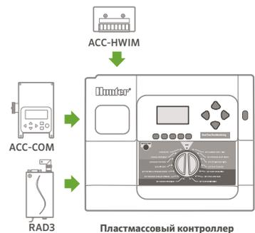
**Коммуникационные компоненты ACC, установленного на стене**
