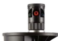
На G885 сектор полива можно отрегулировать в любое время: до или после установки, а также во время полива. Удобное кольцо регулировки сектора полива можно поворачивать рукой или с помощью простого в использовании инструмента. Этот многофункциональный инструмент также может использоваться для удержания выдвинутой штанги в поднятом положении для замены сопел.
