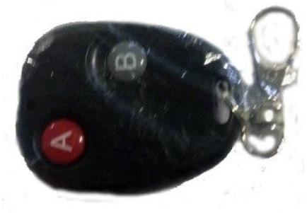
Кнопка В включает/отключает систему, Кнопка А включает/отключает работу через таймер.
